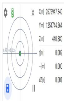
Die Richtung zum theoretischen Punkt wird ebenfalls mit Pfeilen (vorwärts/rückwärts und links/rechts) in Richtung der Totalstation visualisiert.
