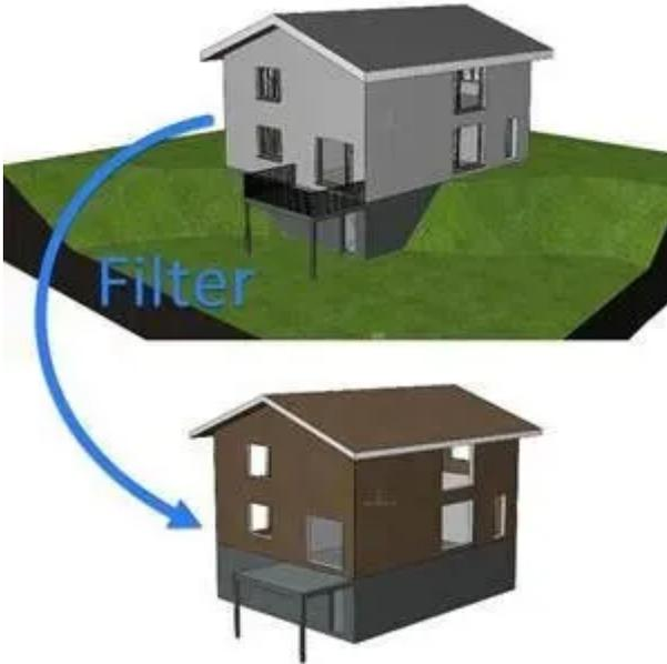
Nutzen Sie dazu die folgenden Funktionen, um das Architekturmodell ohne Räume, Möblierung und Umgebung als Rohbaumodell anzeigen zu können. Der Holzbauplaner benötigt lediglich die herausgefilterten Elemente vom Architekturmodell.
