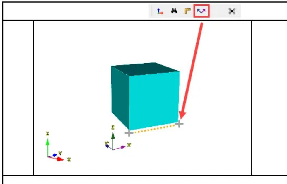
Wenn die Achse neu definiert werden soll, muss man die Funktion mit (M) aktivieren, um die X-Achse neu zu definieren oder mit (R) aktivieren, um die Y-Achse neu zu definieren.
