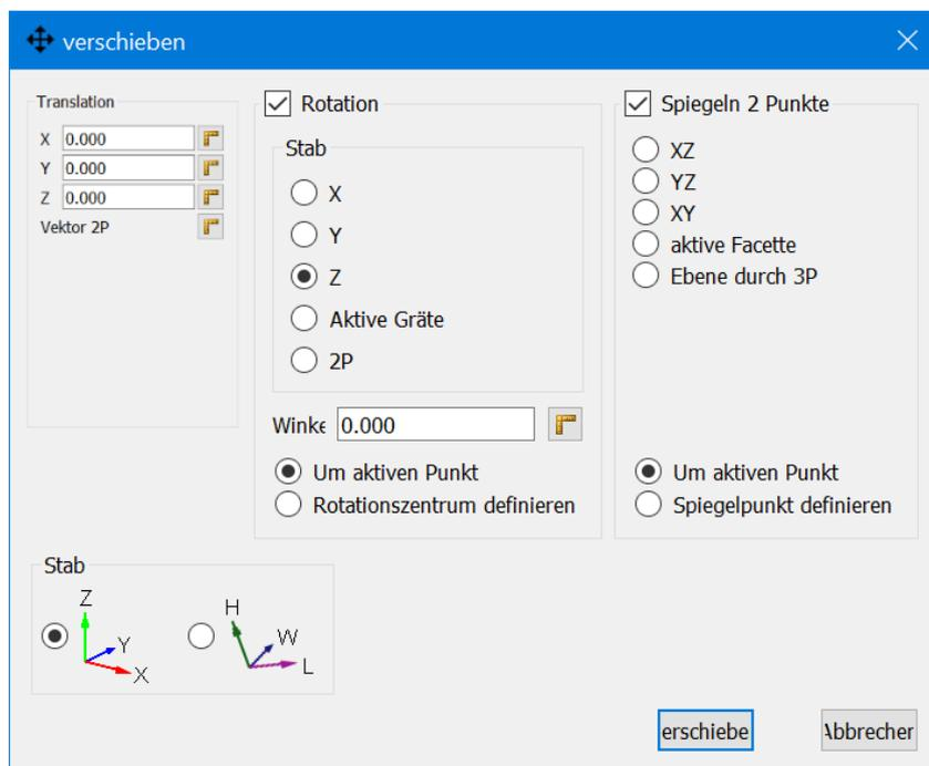
Mehrere Elemente mit unterschiedlichen Z-Höhen können auf die gleiche Z-Höhe verschoben werden.
