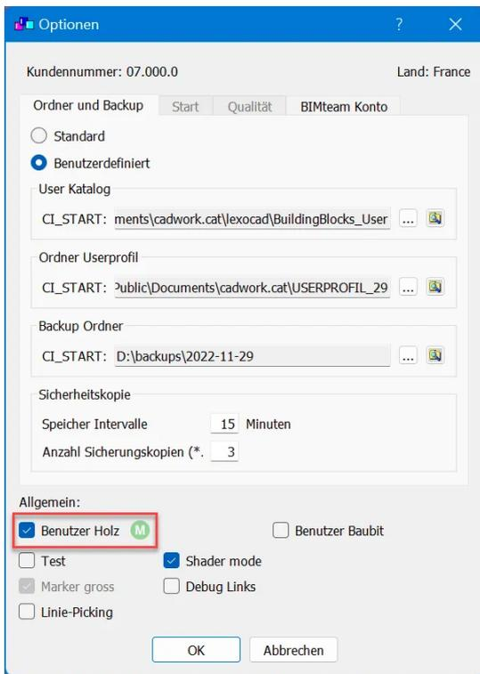
Diese Option ermöglicht es Ihnen, über einen Export direkt mit cadwork 3d zu kommunizieren. Verwenden Sie dazu das Symbol "cadwork 3d exportieren" in der Werkzeugleiste (oben rechts).
