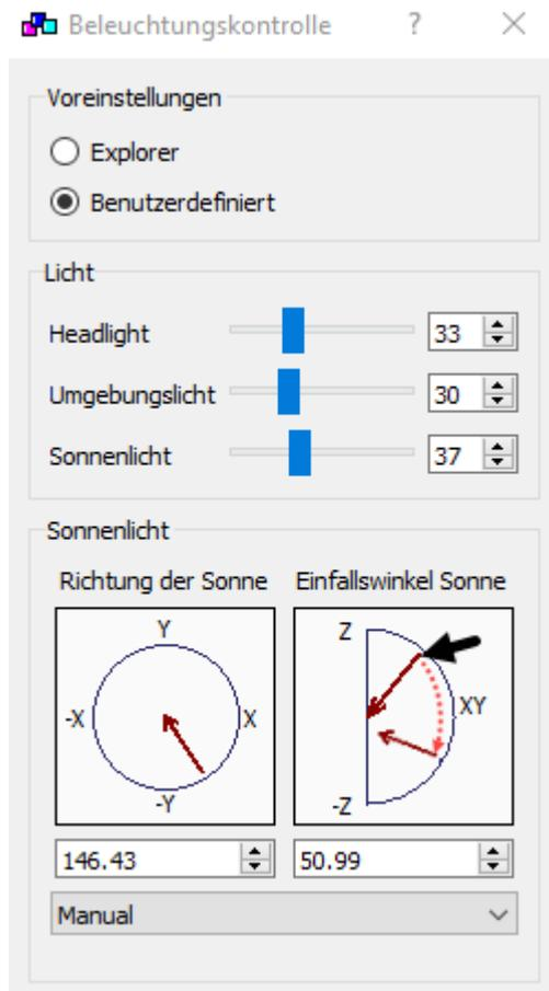
Der Einfallswinkel kann verändert werden, indem man die Richtungsanzeige mit der Maus verschiebt.
