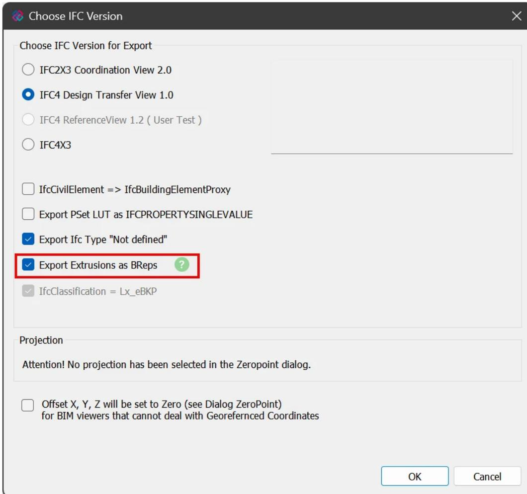
Alle Leitungen (Extrusion) mit 2 Punkten, Anfang und Ende, werden als Geometrie Typ IFCSWEPTDISKSOLID generiert. Dieser Geometrie Typ wird von den meisten BIM Programmen unterstützt.
