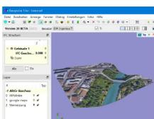
Layer 2 "Vermessung" beinhaltet Vermessungspunkte in der Zone, in welcher die Baugrube erstellt werden soll.
