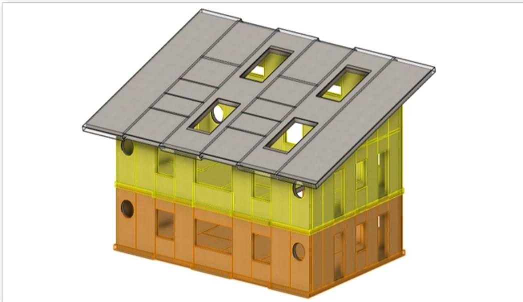
*Ist das Register Platten aktiv, werden für geschachtelte Elemente orangefarbene, für ungeschachtelte gelbe und für ungruppierte weiße Ersatzkörper eingeblendet.*
